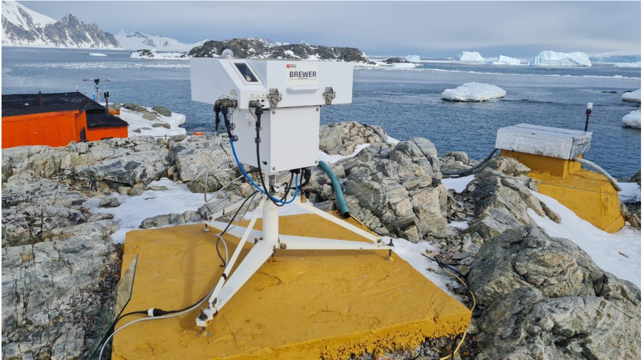
El espectrofotómetro Brewer de Base San Martín esta siendo operado y mantenido por el personal técnico del IAA Ing. Rodrigo Azpilcueta y el Ing. Alvaro Martín Errasquin (2021).
