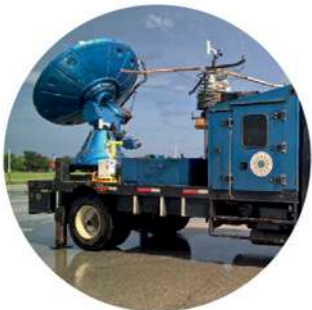
A. Radar Móvil Banda X Dopplet On Wheels (DOW).
